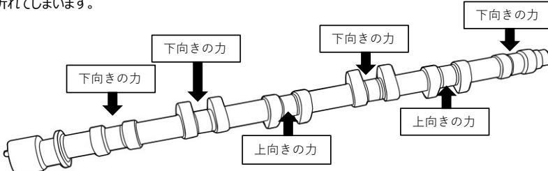
カムシャフトを組み付ける際は、できるだけヘッド面に対してカムを水平に均等に少しづつ締めていくください。
